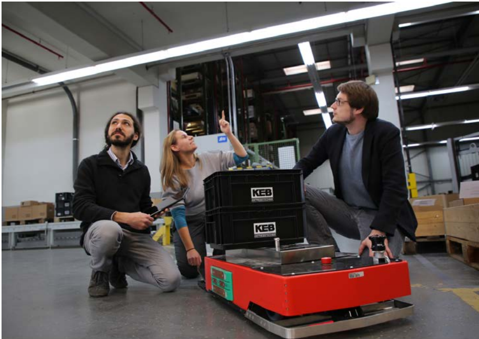
BU: Die Navigation des Transportsystems erfolgt über die Deckenbeleuchtung. Dr. Alexandre Bousaid, Bianca Miene (beide OSRAM) und Tommy Falkowski (Fraunhofer IEM) diskutieren die Technologie. Foto: Fraunhofer IEM
